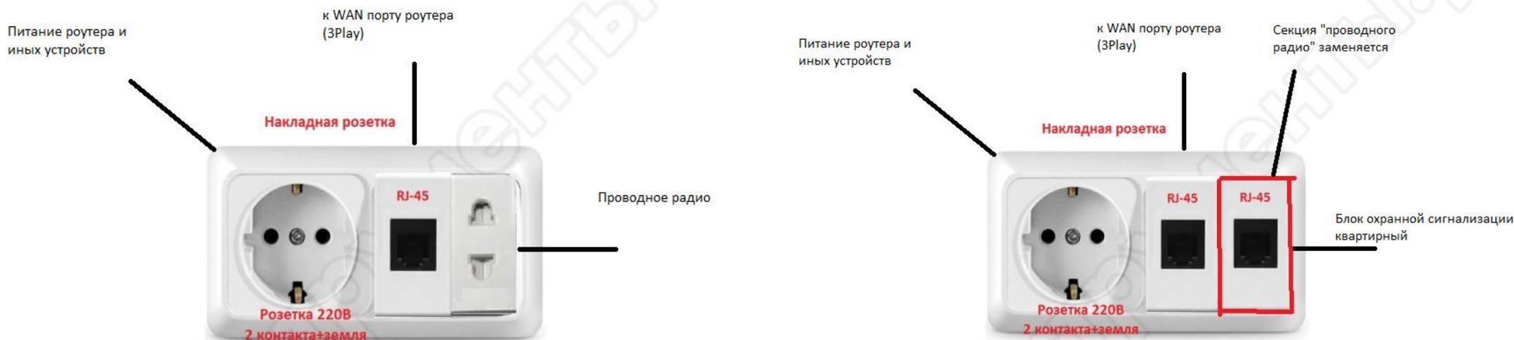
Абонентская сеть строится с использованием UTP cat5e 2x4x0,52 с учетом следующего принципа на этапе сдачи дома в эксплуатацию: 2 пары – ШПД (100Мб/с), 1 пара- проводное радио, 1 пара в резерве (ОТА, домофон и т.д.). В последующем, после сдачи объекта в эксплуатацию возможно использование 1 резервной пары и 1 пары радиодифференциации для подключения устройств сигнализации.
