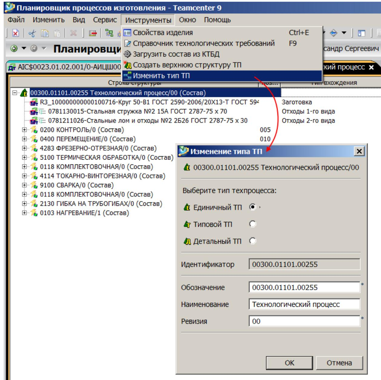
Автоматизация процедуры замены типа ТП (типовой/групповой - единичный) для выбранных изделий. Сокращение трудоемкости при замене типа с **5** мин до **1** мин.
