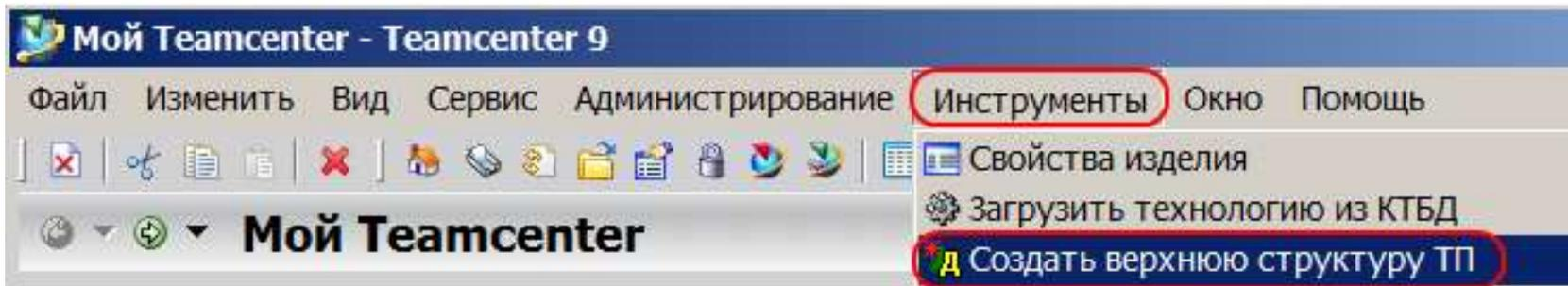
Реализовать механизм Автоматического массового формирования "шапок" технологических процессов. Сокращение времени на формирование предварительных ВСНРМ (с 90 мин до 45 мин. Для изделия из 20 компонентов)
