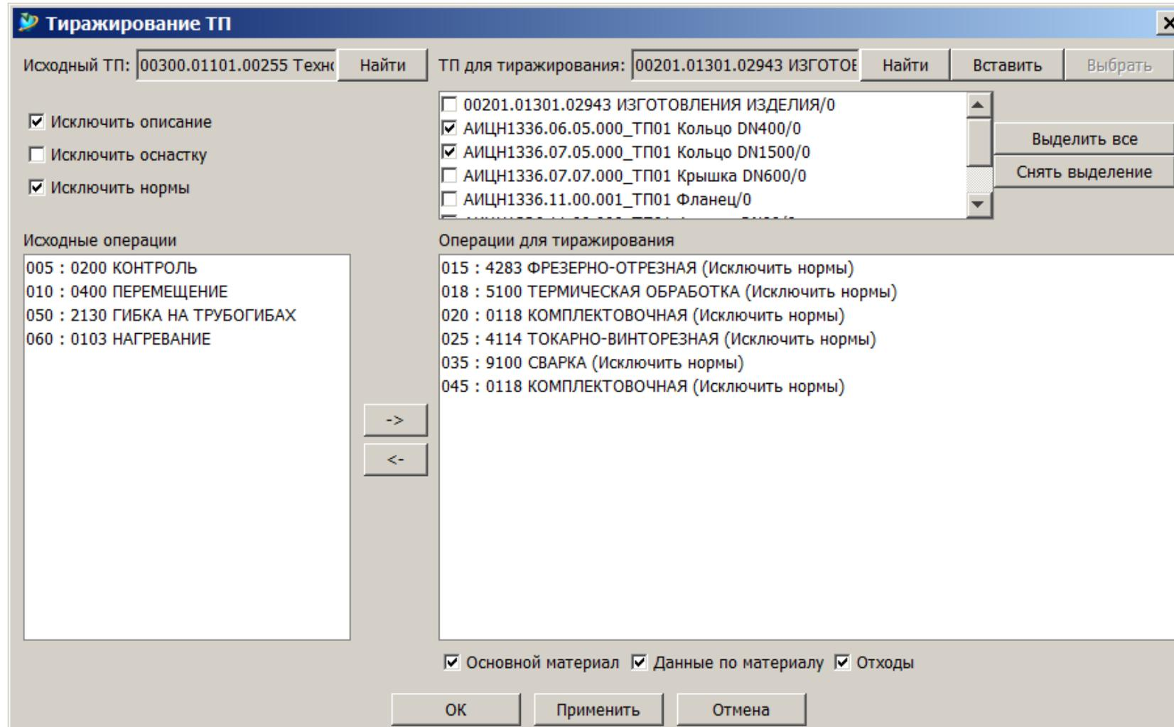
Интеллектуальное клонирование технологических процессов. Сокращение времени на корректировку клонированных технологических процессов (до 12 мин. на одну деталь).
