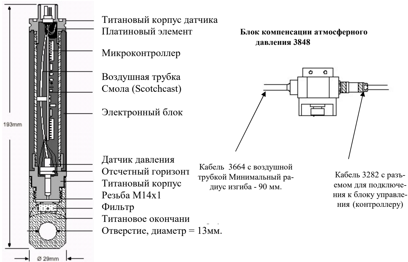
Рис. 3. Принципиальная схема датчика уровня.
