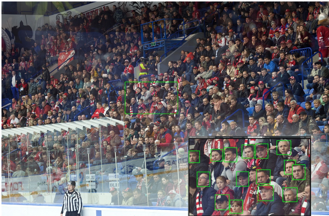
Распознавание лиц на трибунах с видеопотока камер обзорного видеонаблюдения
