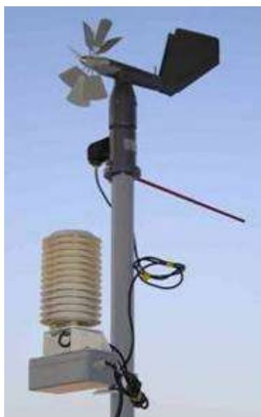
Фото - 6 Расположение датчика скорости и направления ветра на МГП-1 Усть-Луга-Порт.
