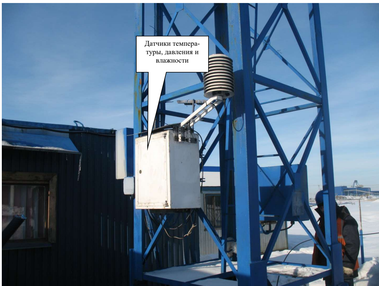
Фото 5 - Расположение датчиков температуры, давления и влажности воздуха на МГП-1 Усть-Луга-Порт
