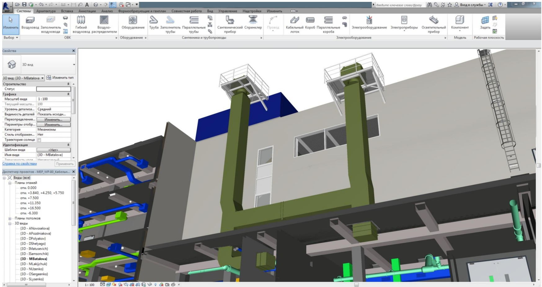
Проектирование систем дымоудаления из помещений F1.L1.R047 и F1.L1.R048
